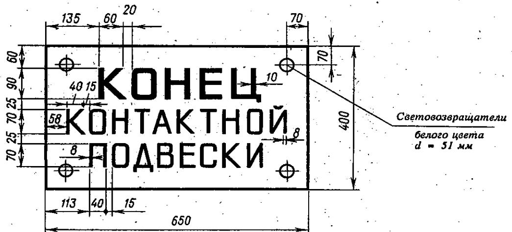
Знак устанавливается в пределах станции перпендикулярно оси пути на границе контактной сети. Знак крепится на контактном проводе цепной подвески в тех местах, где отходящий в сторону контактный провод находится на расстоянии 400 мм от оси токоприемника или перед включенным в контактный провод изолитором. Буквы черного цвета на белом фоне, могут быть вырезаны.
