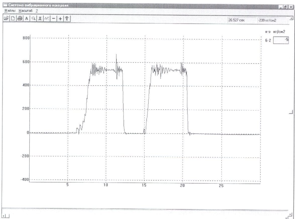
Рис. 6. Тарировка системы измерения напряжений. 2 кгс.
