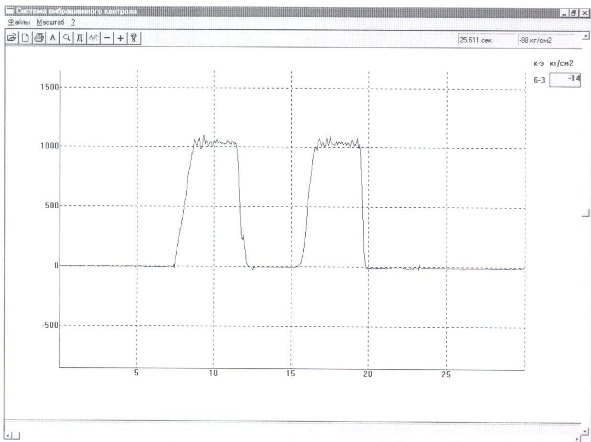
Рис. 7. Тарировка системы измерения напряжений. 4 кгс.
